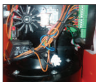
Εσωτερική δομή καυστήρα με τις ηλεκτρικές συνδέσεις
