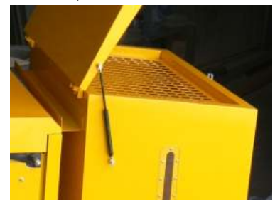
Το σιλό, με το αμορτισέρ, τη σίτα και τη θυρίδα επιθεώρησης
