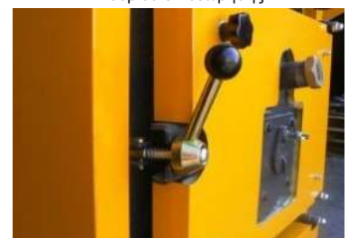
Πόρτα τροφοδοσίας λέβητα, με χερούλι, θυρίδα επιθεώρησης φλόγας και ρύθμιση δευτερεύοντα αέρα καύσης
