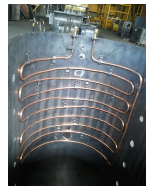
Σερπαντίνα εναλλαγής θερμότητας με χάλκινη σωλήνα
