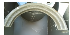
Μαντεμένιο τόξο για καθοδήγηση των καυσαερίων
