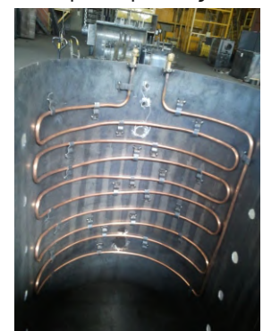
Σερπαντίνα εναλλαγής θερμότητας με χάλκινη σωλήνα
