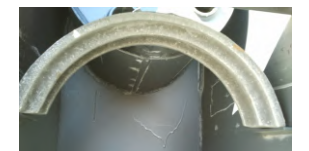
Μαντεμένιο τόξο για καθοδήγηση των καυσασερίων
