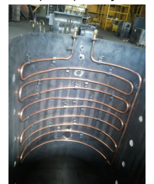
Σεργπαντίνα εναλλαγής θερμότητας με χάλκινη σωλήνα
