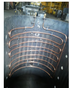
Σερπαντίνα εναλλαγής θερμότητας με χάλκινη σωλήνα
