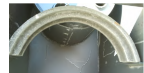
Μαντεμένιο τόξο για καθοδήγηση των καυσαερίων
