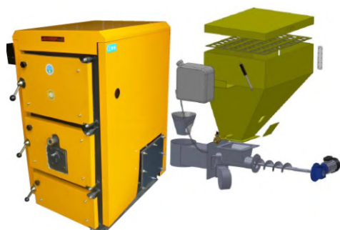
Λέβητας MCL-F (με φλάντζα για σύνδεση τροφοδότη) και τροφοδότης βιομάζας με κοχλία
