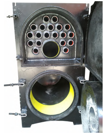
Εσωτερικό λέβητα PLS με το θάλαμο καύσης μεγάλων διαστάσεων (κάτω) και τον αυλό δεύτερης και τους αυλούς τρίτης διαδρομής (πάνω)
