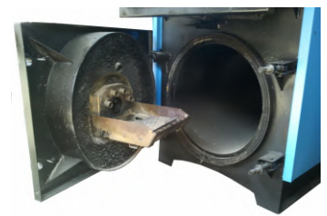
Κάτω πόρτα με τοποθετημένο τον καυστήρα PV-180a με δευτερογενή αέρα καύσης και κινούμενες σχάρες οι οποίες καθαρίζουν από τη στάχτη αυτόματα
