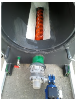
Κοχλίας αυτόματης απομάκρυνσης στάχτης εντός του θαλάμου καύσης και ηλεκτρομειωτήρας (έκδοση Pellex)
