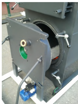
Κάτω πόρτα με βαγονέτο απομάκρυνσης καυστήρα (εύκολος καθαρισμός κεφαλής καυστήρα pellet)
