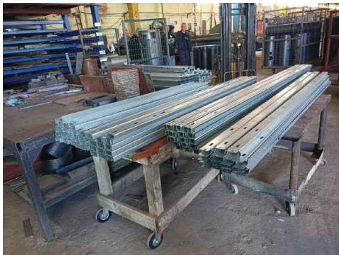
ΠΑΡΑΓΩΓΗ ΒΑΣΕΩΝ-ΣΤΗΡΙΓΜΑΤΩΝ ΗΛΙΑΚΩΝ ΑΠΟ ΓΑΛΒΑΝΙΣΜΕΝΗ ΛΑΜΑΡΙΝΑ ΔΚΡ ΒΑΡΕΩΣ ΤΥΠΟΥ
