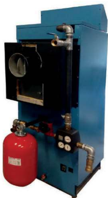
Μονάδα Ξύλου TITANUS Unit, Με Τρίδοδη βάνα φορτίου, ηλεκτρονικό κυκλοφορητή, δοχείο διαστολής, κρουνό εκκένωσης, υδραυλικά εξαρτήματα
