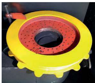
Έκδοση τροφοδότη KL με σύστημα απομάκρυνσης στάχτης από την εστία καύσης για αποφυγή του φαινομένου Klinger
