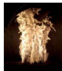
Πλήρως ανεπτυγμένη φλόγα τροφοδότη βιομάζας
