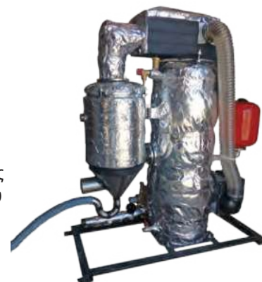
Συγκρότημα καύσης e-Line με κυλινδρικό λέβητα
