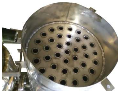
Σωλήνες καυσαερίων στο εσωτερικό του εναλλάκτη συμπύκνωσης
