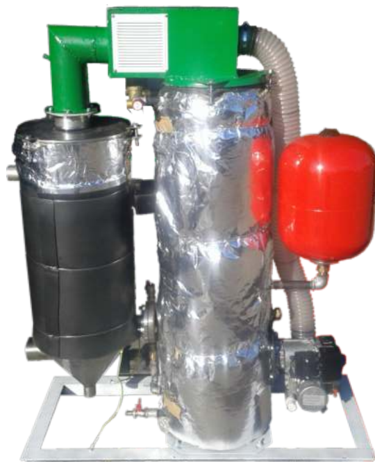
Συγκρότημα καύσης με συμπύκνωση των καυσαερίων e-Line-50
