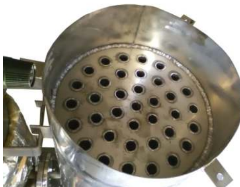
Σωλήνες καυσαερίων στο εσωτερικό του εναλλάκτη συμπύκνωσης
