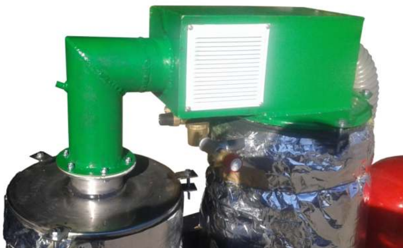
Θάλαμος προθέρμανσης αέρα καύσης και αγωγός προσαγωγής των καυσαερίων στον εναλλάκτη συμπύκνωσης
