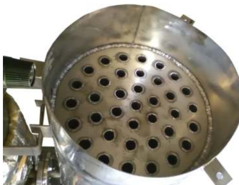
Σωλήνες καυσαερίων στο εσωτερικό του εναλλάκτη συμπύκνωσης
