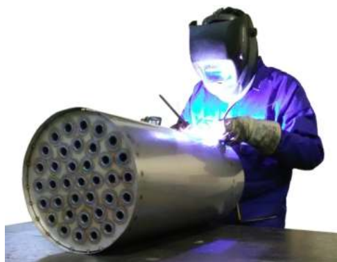
Κατασκευή εναλλάκτη συμπύκνωσης από ανοξείδωτο χάλυβα και συγκόλληση TIC
