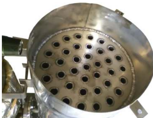
Σωλήνες καυσαερίων στο εσωτερικό του εναλλάκτη συμπύκνωσης
