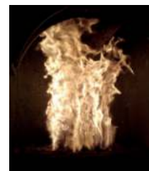
Πλήρως ανεπτυγμένη φλόγα τροφοδότη βιομάζας
