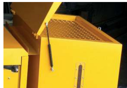
Το σιλό, με το αμορτισέρ, τη σίτα και τη θυρίδα επιθεώρησης
